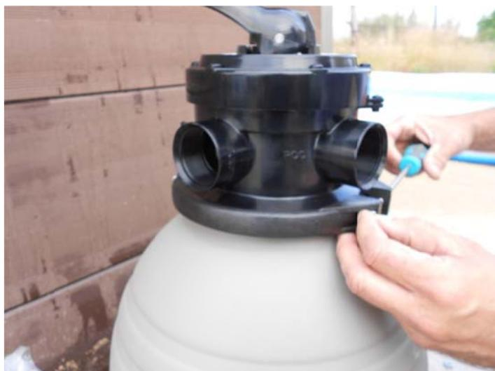
6. Colocación de los racores de conexión: Se han de colocar dos en la bomba, y dos en la válvula, uno en la entrada que da a la bomba y el otro en la salida perpendicular. El orificio que queda es el de desagüe y allí se pone el tapón. Opcionalmente se le puede colocar el cuarto racor para conectarlo a una manguera de desagüe, en caso de que se desee.
