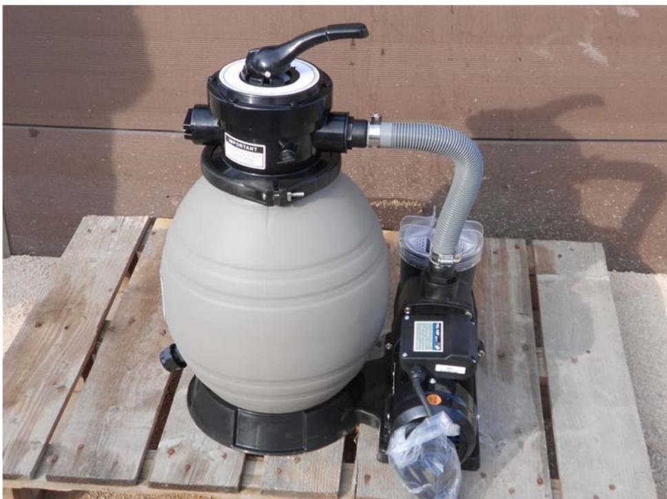
8. Montaje del manómetro: Destapamos el tapón lateral de 3/8" que tiene la válvula en su lateral, enfrente si miramos dejando a la derecha la bomba. Ponemos teflón al manómetro y lo roscamos en el orificio. No es necesario apretar mucho, bastará con un poco y que la escala quede bien puesta.
