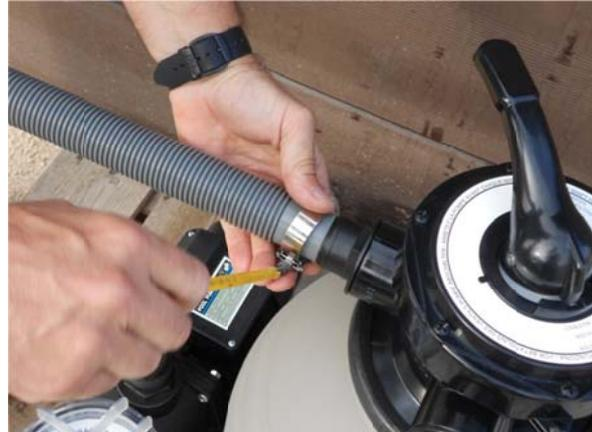
EL otro extremo va a la salida vertical de la bomba:
